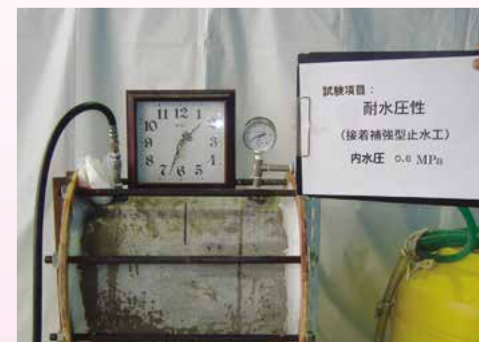
耐水圧試験(接着補強型止水工)
